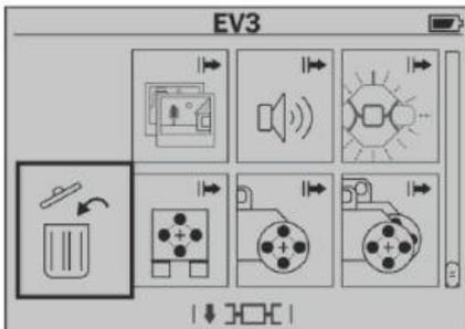
4. Добавь команды «Большой мотор» и «Таймер» друг за другом, как на картинке. Порт большого мотора (по умолчанию - D) поменять нельзя. Но можно поменять мощность. Время на таймере поменяйте на 60 секунд, щелкнув по блоку с часами центральной кнопкой блока EV3.
